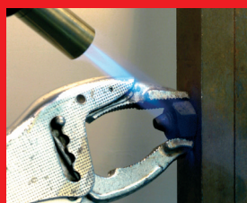
Dégrippage d'objets métalliques oxydés
